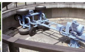
走踏試験機(4tトラックを想定した踏みつけや接触による耐久性を評価)
