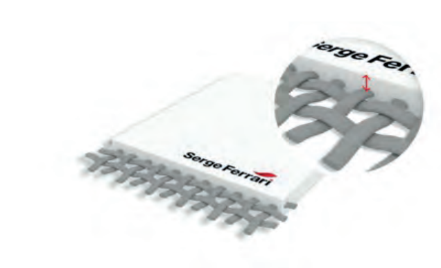
Matériaux Serge Ferrari : enduction de l'armature en fils polyester haute ténacité par des couches de polymères hautes performance
